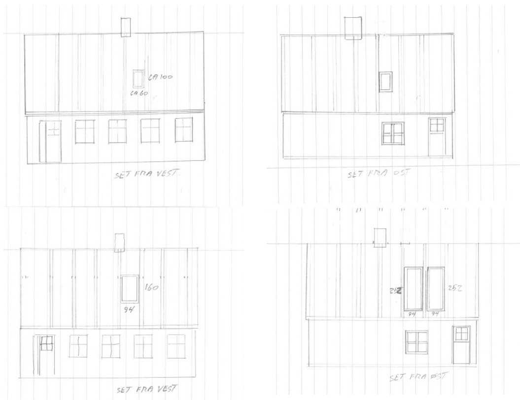
Figur 2, tag og facade mod vest vist til venstre, henholdsvis eksisterende forhold øverst, og nye forhold. Til højre ses tegninger af det østlige tag og facade.
