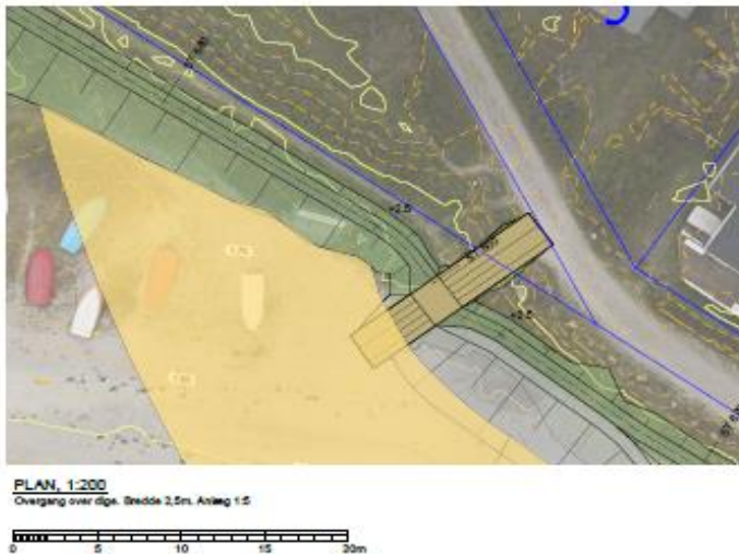
Fig. 5. Fremsendt tegning til illustration af overgang, der ønskes etableret i delområde 1b på grænsen til 1c.
