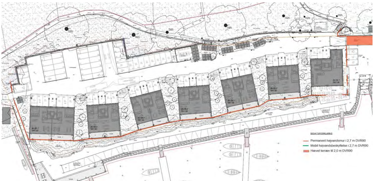
Figur 13 Højvandsmuren med topkote på 2,7 m DVR90 består af samlet 6 in situ-støbte mure (røde linjer), der foran husene udgør samlet havværts terrassemur og er forbundne med hævet terræn havværts og mellem husene. I det østligste hus er der café og derfor behov for mere mobil højvandsbeskyttelse – her vist åbnet til "sommerbrug".
