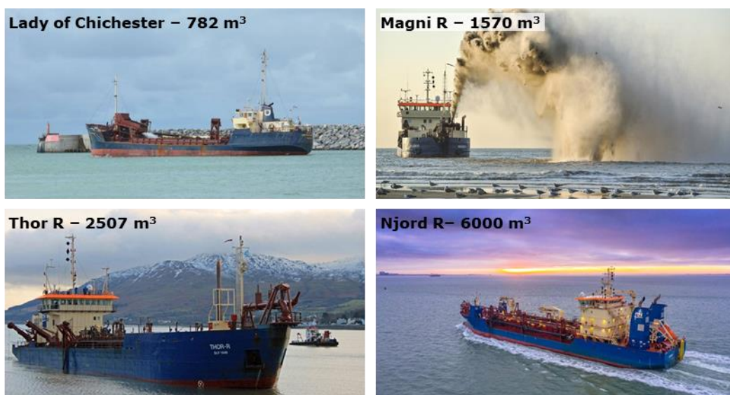
Figur 1-7. Eksempler på dredgers i forskellige størrelsesklasser, som er observeret langs Vestkysten i løbet af år 2022.
