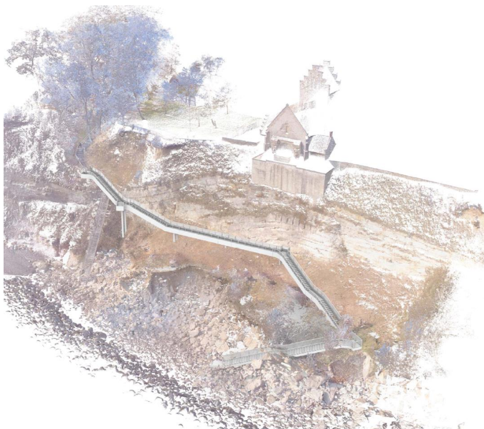
Fig. 2: trappe og bangbro, fornyet koncept - første del på fritstående master, nederste del med skruefundament (fra ansøgning)
