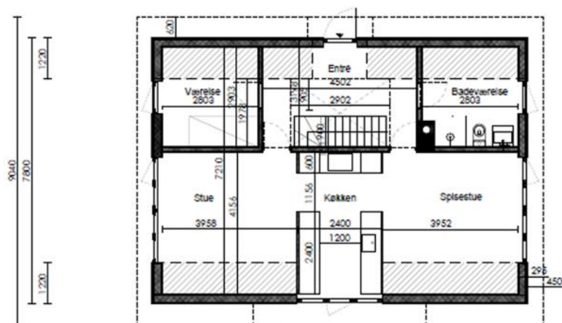
Grundplan nyt sommerhus (skraveret areal er den "u-udnyttelige del med stærkt faldende rumhøjde) - Tagplan og kælder under
