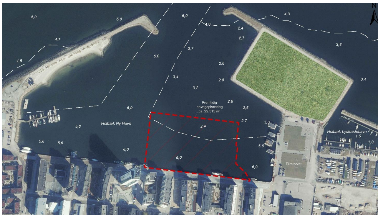
Luftfoto af den eksisterende forhold med placering af fremtidigt anlæg
