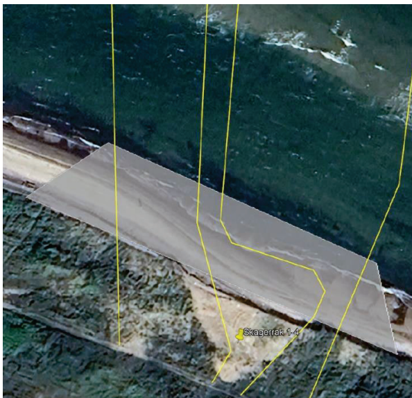
Figur 2-2 Skitse af det areal ('puden'), hvor der skal udlægges småsten (grå polygon), så kablerne (gule streger) er dækket.
