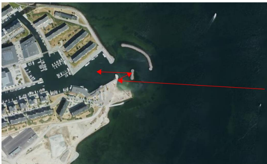
Figur 2 – Simpel illustration af hvordan østlige bølger reflekteres og skaber bølgeuro i havnebassinet.
