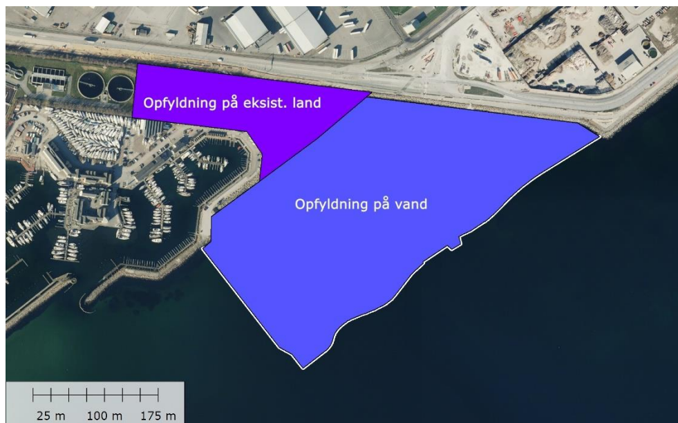
Figur 1-3 Placering af Aarhus ReWater. Landopfyldning på vand er angivet med en blå farve og bagkant stenkastning med hvid. Det eksisterende landområde, der indgår som en del af Aarhus ReWater, er angivet med en lilla farve.
