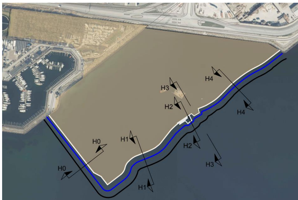
Figur 1-9 Planskitse af kystindfatning langs Aarhus ReWater. Brun: landopfyldning, hvid: bagkant bølgeskærm/kantsten, blå: vandlinje, sort: kystindfatningens fodaftryk.
