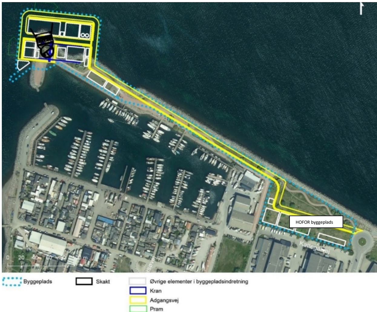
Figur 3. Kommende byggeplads og udledningspunkt fra HOFOR.
