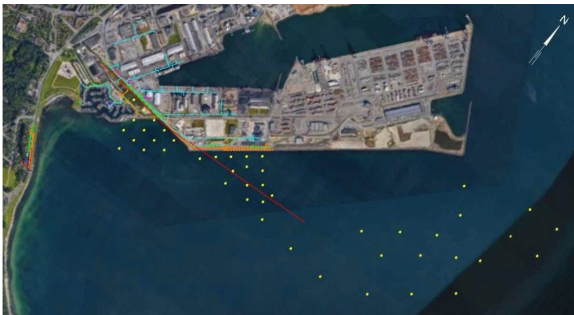
Figur 9 Ledninger i området omkring projektet i henhold til LER søgning ifm. borekampagnen i 2019-2020. Rød linje: Eksisterende udløbsledning fra renseanlæg. Gule prikker: Geotekniske boreriger.
