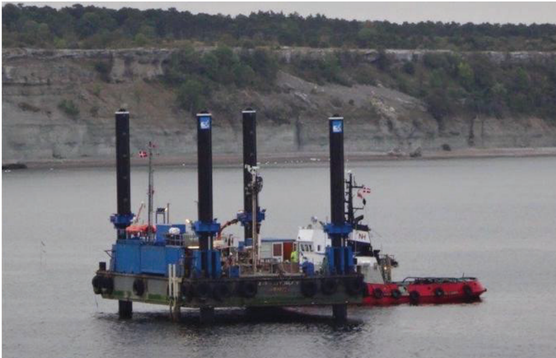
Figur 7 Foto af jack-up med borerig.
