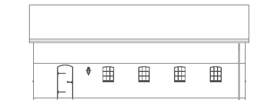
FACADE ØST – Eksis. Fårestald Tag: Stål tag Mur: Hvid vandskuret og Trætrempel
