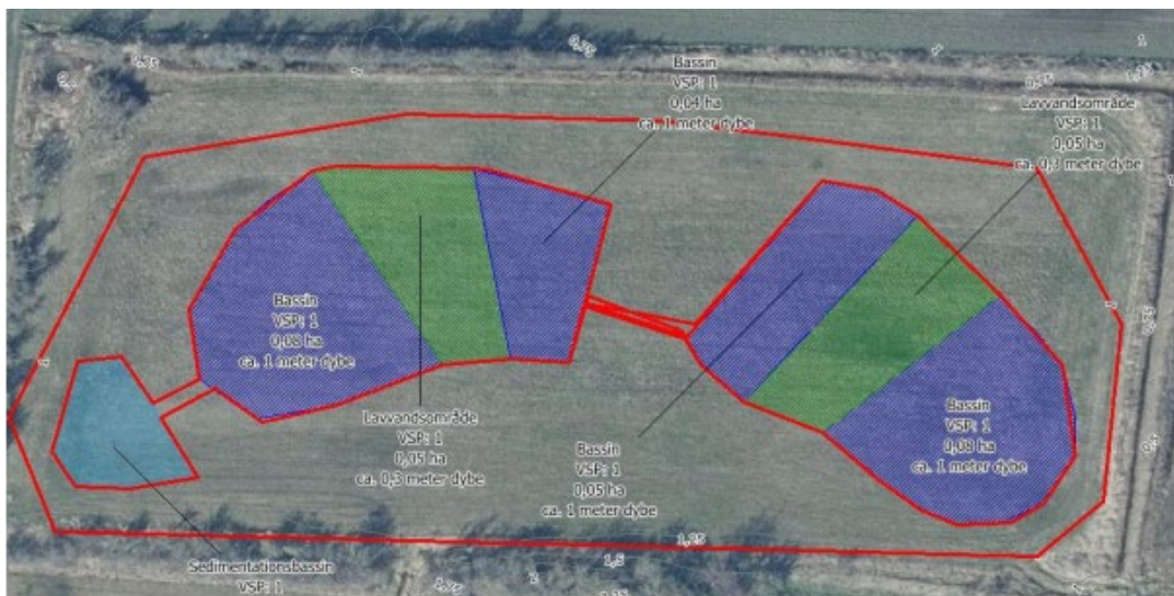
Figur 1: Forslag til nyt design af Minivådområdet.
