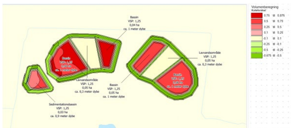
Figur 8: Volume beregning i forbindelse med Minivådområdet.
