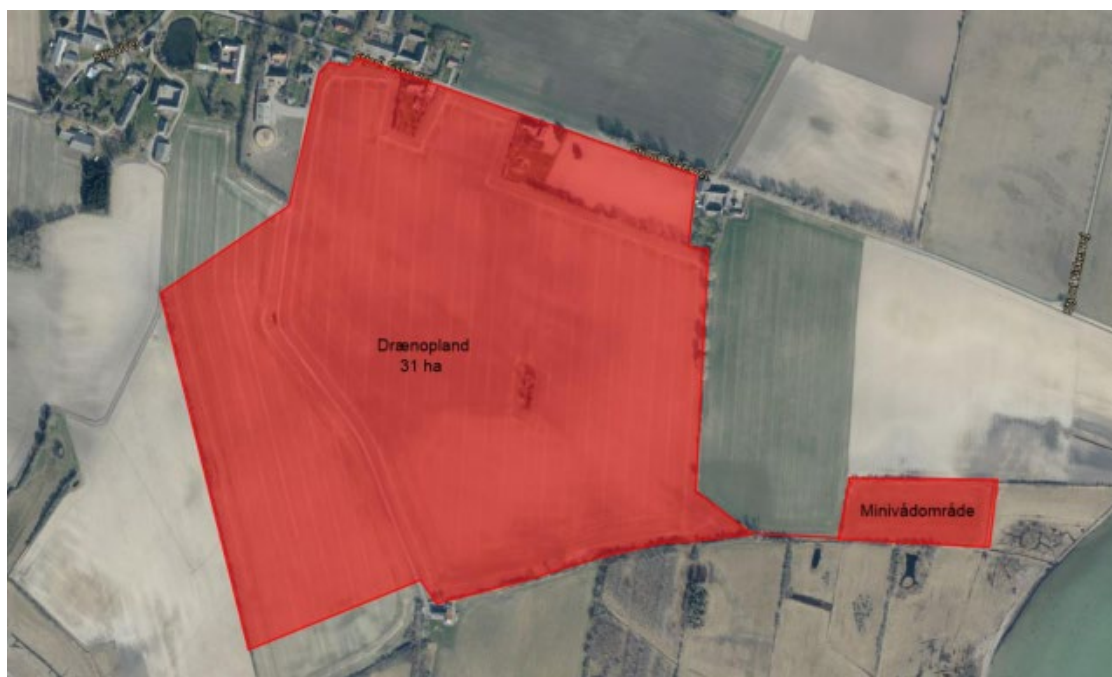
Figur 3: Drænoilandet til det planlagte Minivådområde
