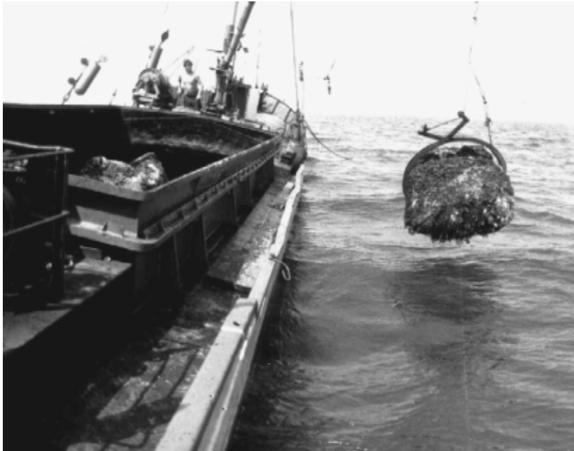
Abbildung 1: Steinzangerschiff „A.M.4“ beim Hieven eines Ostseefindlings mit der Zange
