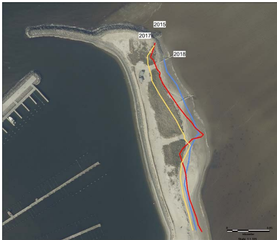
Figur nr. 3 ortofoto fra 2020 der viser at kystskrænten næsten er eroderet ind til 2015 niveau igen.
