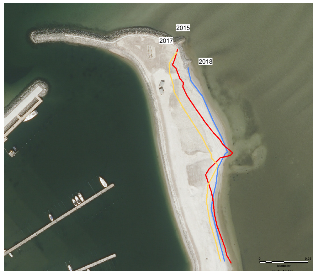
Figur nr. 3 viser kystskrænten i 2018, 2017 og 2015 (ortofoto fra 2018). Viser at der lavet en opfyldning i 2018.
