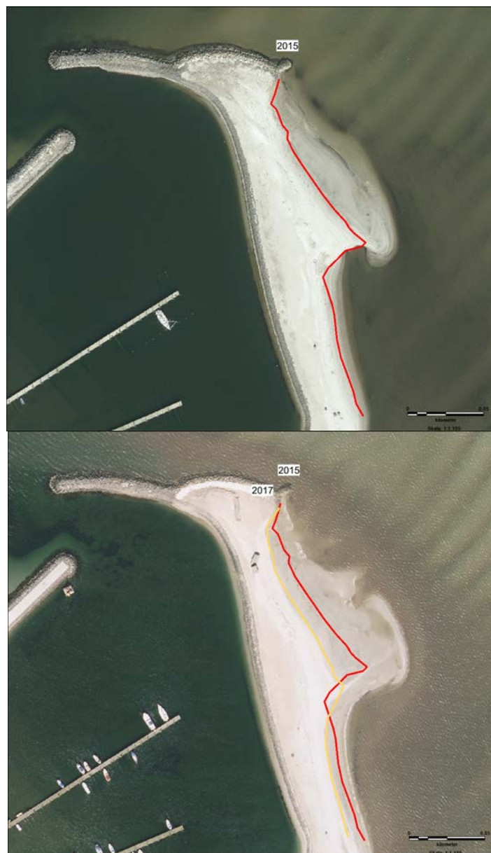
Figur nr. 2 viser skræntlinje på den nordlige del af den østlige mole i 2015 (ortofoto fra 2015) og i 2017 (ortofoto 2017)
