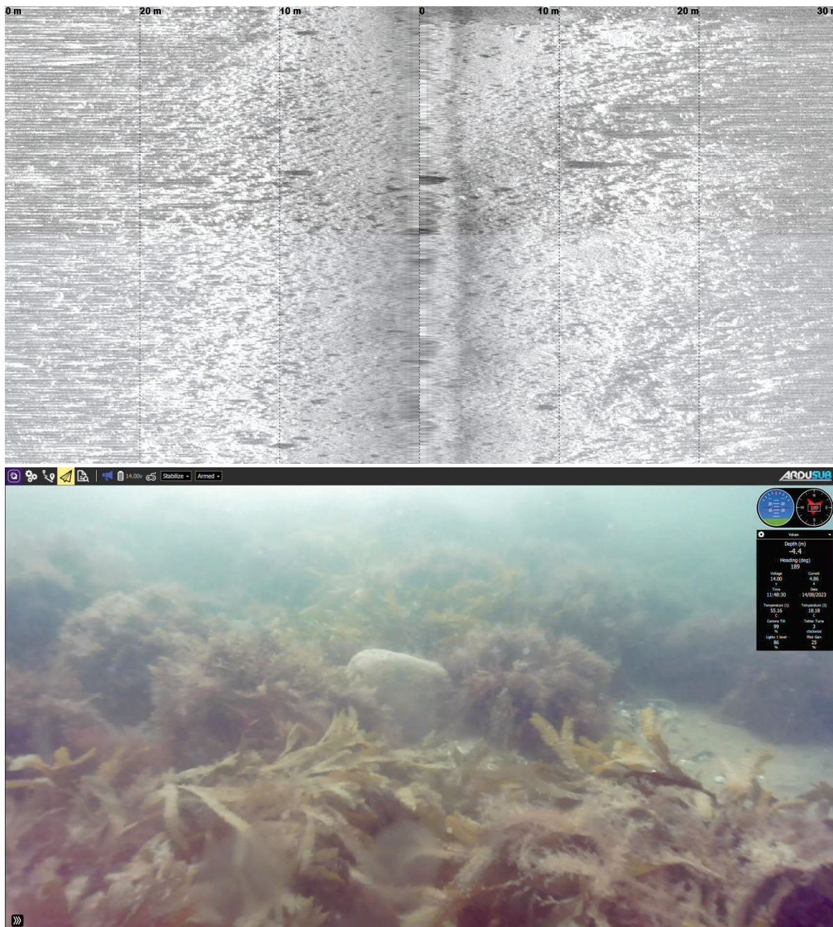
Figur 4-8. SSS-eksempel af en substrattype 4 bund, med over 25% spredte sten på >10 cm størrelse. Eksemplet er fra den sydvestlige del af efterforskningsområdet ved ROV-station "C_04", der viser en sandbund med mange store sten dækket af makroalger – primært brunalger i form af savtang og blæretang samt en del buskformede rødalger.
