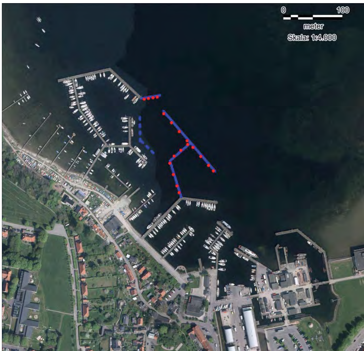
Figur 1: Oversigtskort; projekterede agterpælsrækker samt flydebroer og bølgebryder med glidepæle. © Geodatastyrelsen.
