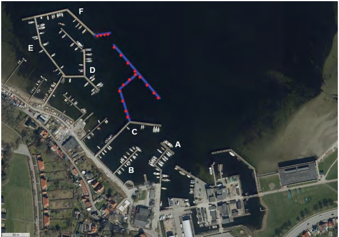
Figur 9 Skitse over det foreslåede havneprojekt projekterede agterpælsrækker samt flydebroer og bølgebryder med glidepæle. Se også Bilag 1. ©MiljøGIS
