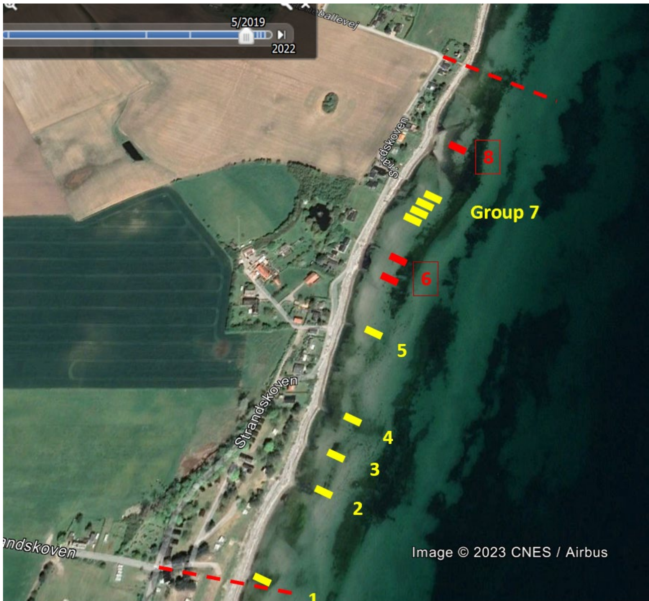
Figur 6. Luftundersøgelse fra 2019 – Svarer også til den nuværende situation i 2023 i forhold til antal høfder. I rødt de høfder, der er blevet ændret siden 2005.
