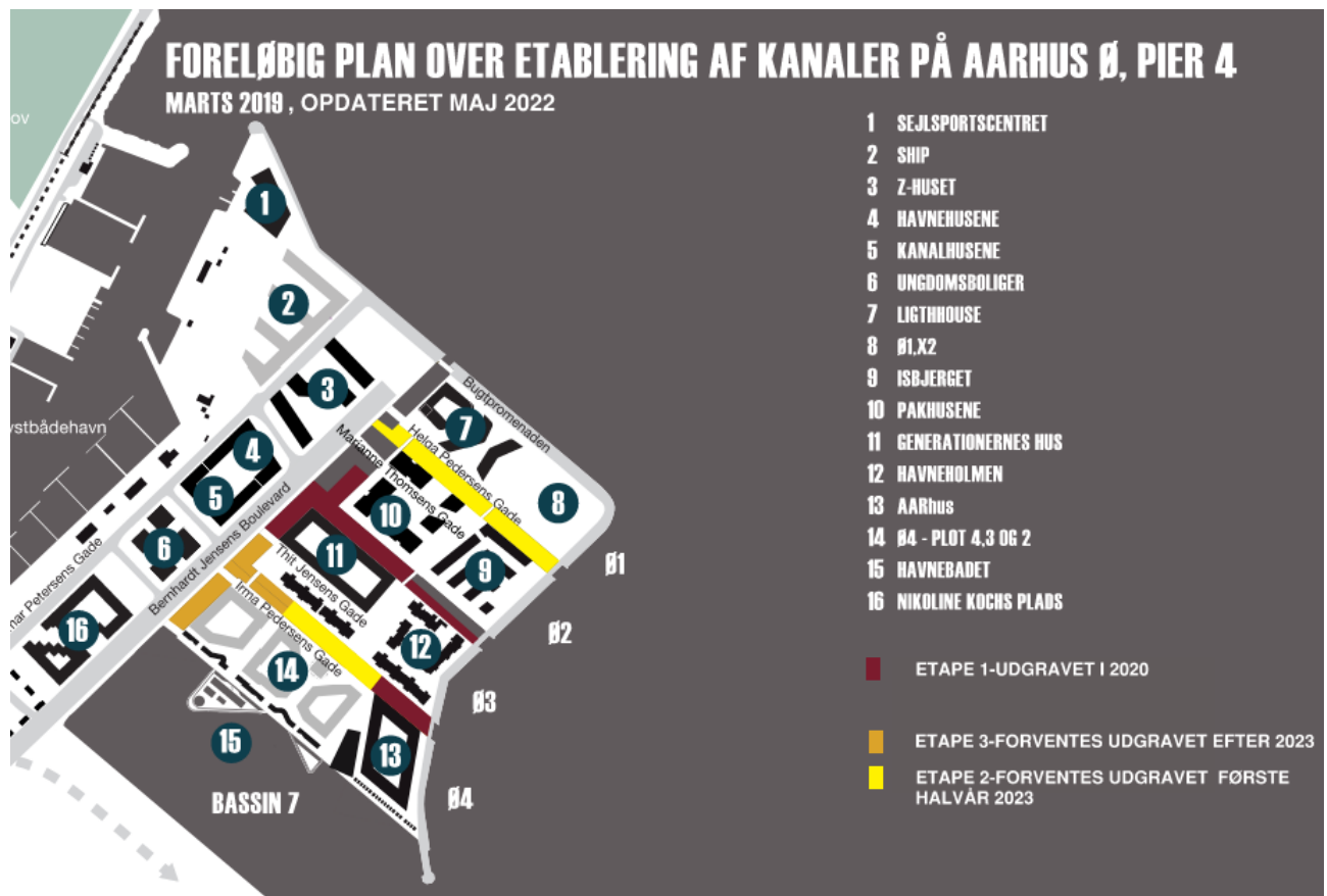
Figur 3 Etapevis udgravning af kanaler. Planen er opdateret i forhold til Aarhus Kommunes udbudsmateriale i 2019, bilag 7.
