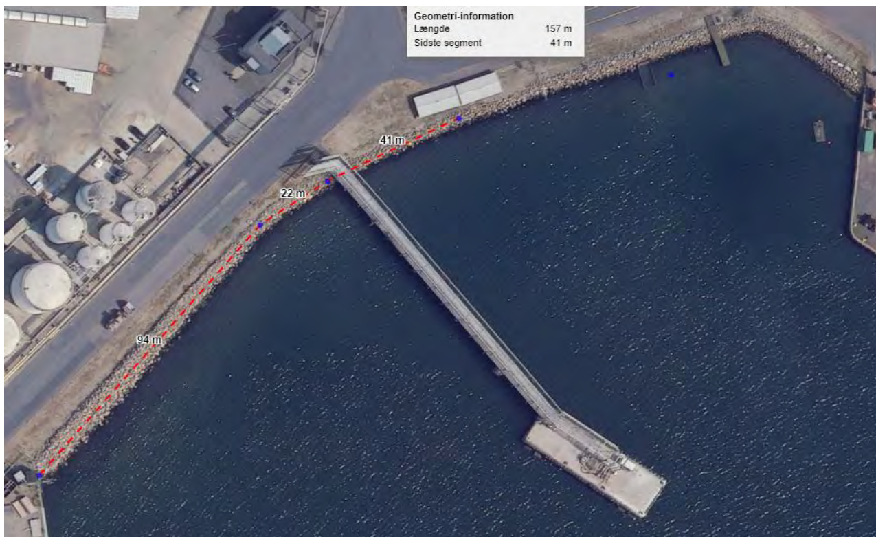
Figur 2-1 Nuværende kaj 23 med skråningsbeskyttelse. Den viste længdemåling angiver den omtrentlige strækning på ca. 160 m, hvori sten vil skulle genanvendes.
