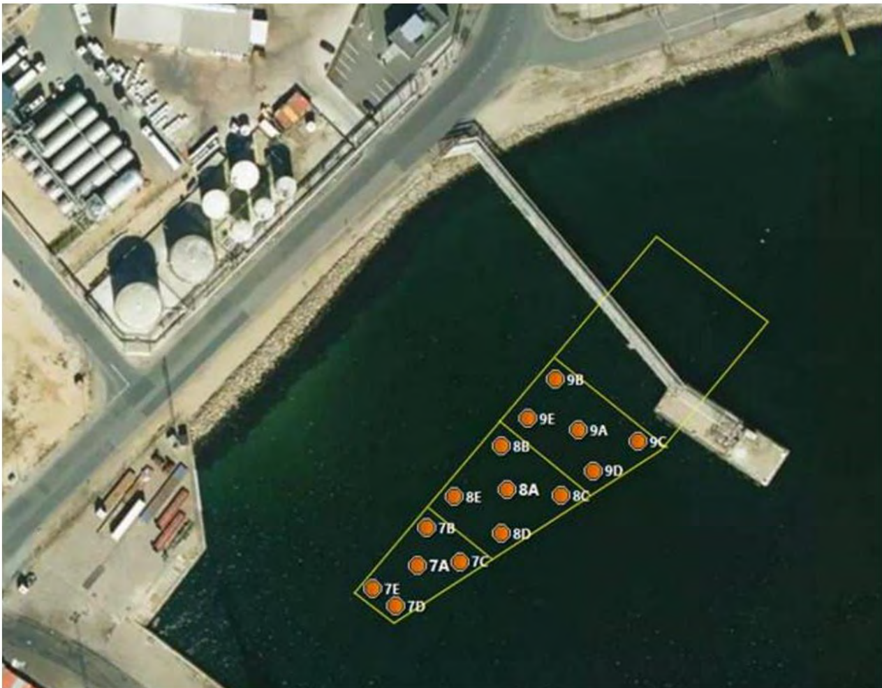
Figur 2-5 Reanalyse af sedimentprøver ved delområde 23.6 bestående af tre nye blandingsprøver af 5 delprøver udført ved Kaj 23 i Centerhavn, Fredericia (Sweco 2021, Miljøkonsekvensrapport – Fredericia Havn) 4 .
