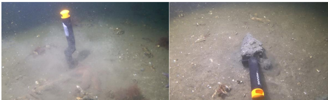
Foto 3 og 4. Et nedstik gennem den øverste blødbund på 5-10 cm giver fast bund bestående af fint sand.
