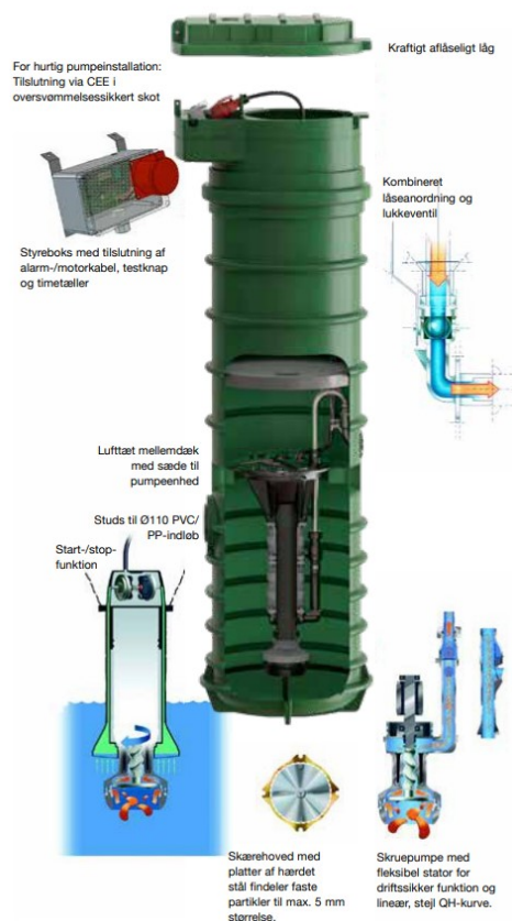
Fig. 6. Tilsendt fra ansøger. På figuren ses en illustration af pumpestation og dæksel, der etableres ved de 20 ejendomme.
