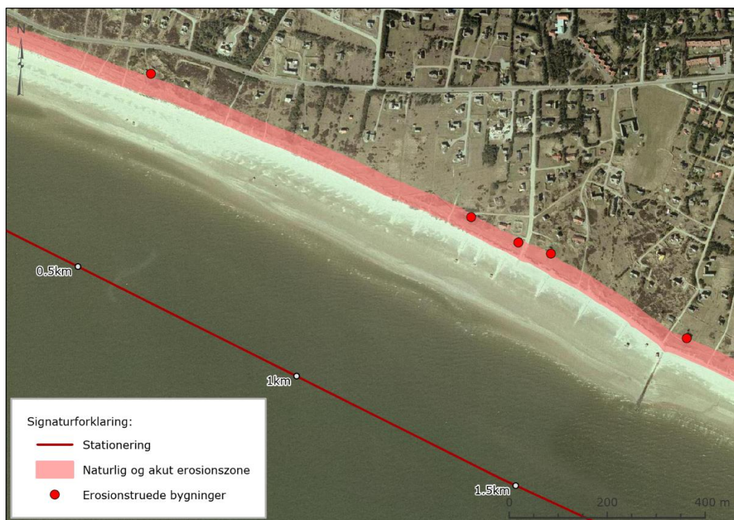
Figur 5-4. Formodet tilbagerykning langs strækningen ved Blåvand som følge af den gennemsnitlige årlige tilbagerykning og den akutte erosion under en 100-års hændelse samt de bygninger, der er erosionstruet på den vestlige del af strækningen.
