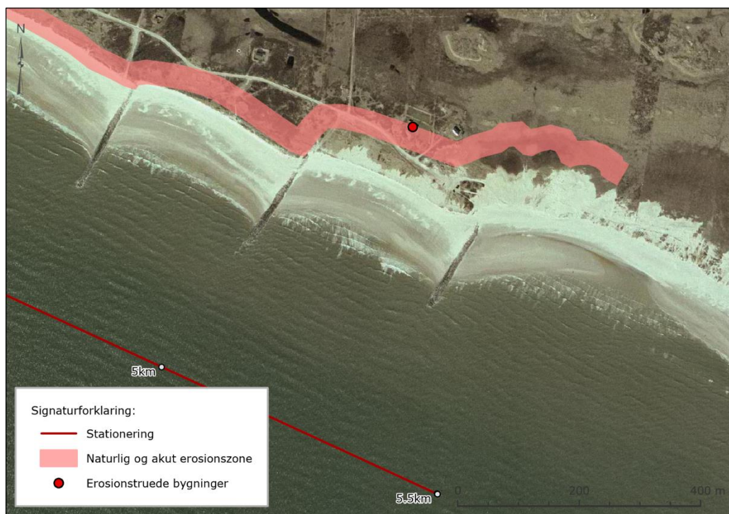
Figur 5-5. Formodet tilbagerykning langs strækningen ved Blåvand som følge af den gennemsnitlige årlige tilbagerykning og den akutte erosion under en 100-års hændelse samt de bygninger, der er erosionstruet i den østlige del af strækningen.
