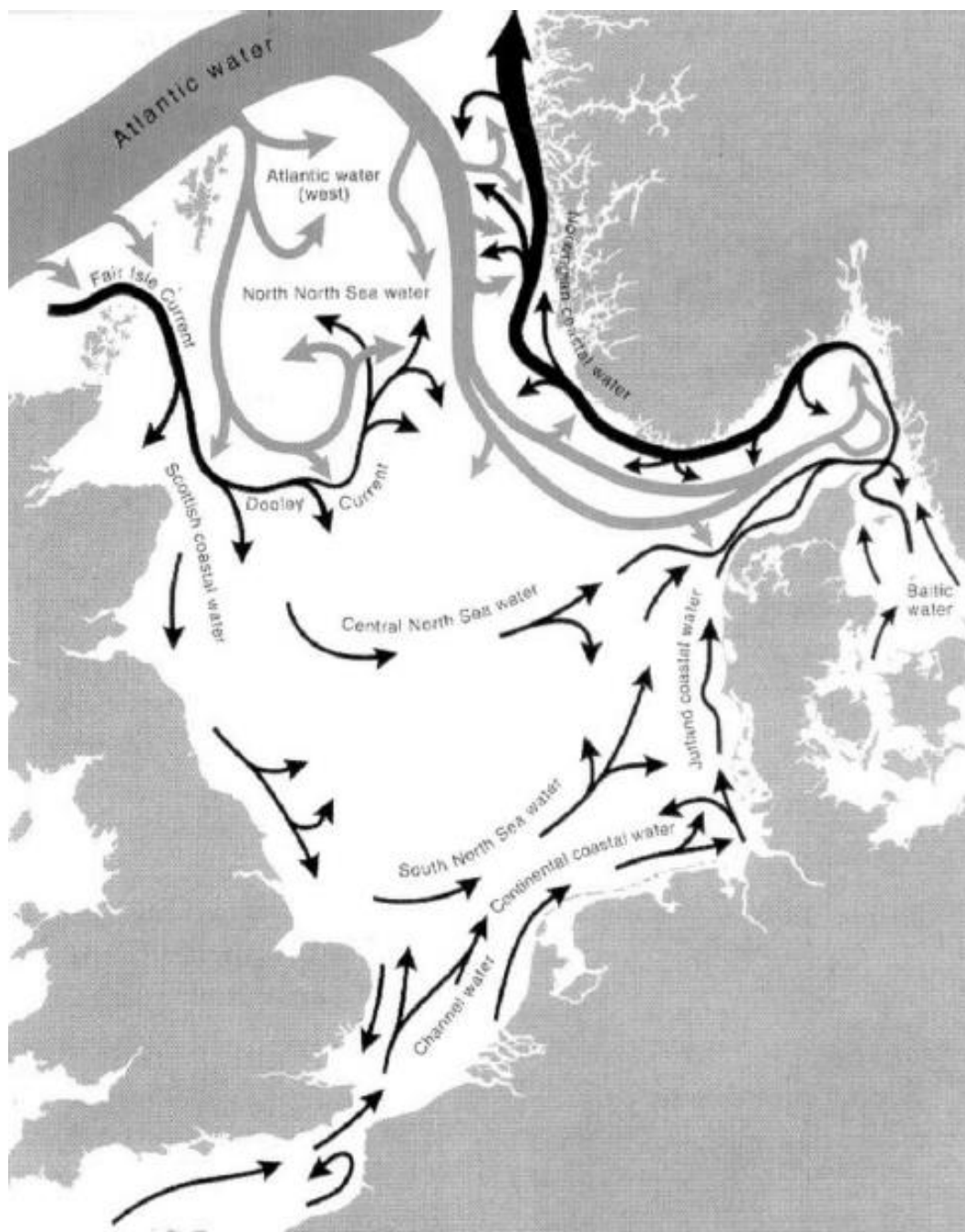
Figur 8-8. Skematisk gengivelse af netto-cirkulationen i Nordsøen, Skagerrak og Kattegat. Mørke pile viser strømninger i overfladen, og de lyse pile viser dybereliggende strømme. Bredden på pilene indikerer styrken 95 .
