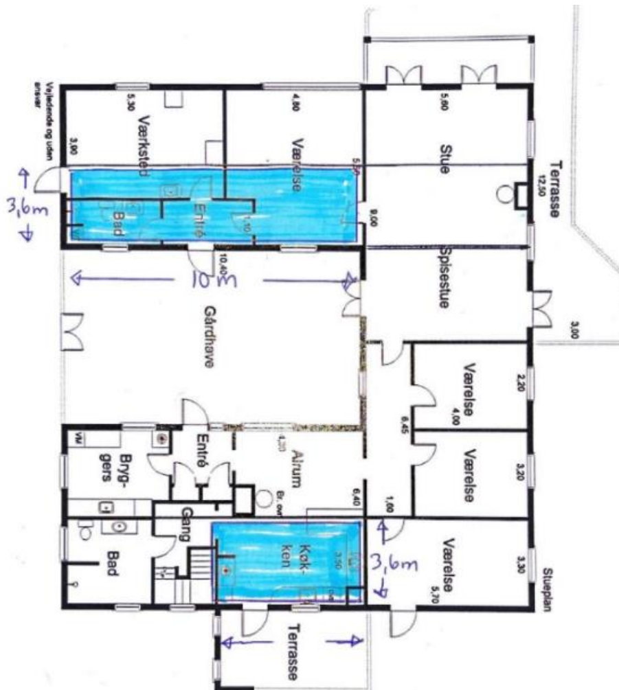
Fig. 3. Plantegning med mål. De blå skraverede arealer er de ønskede placeringer af solcellerne på taget.
