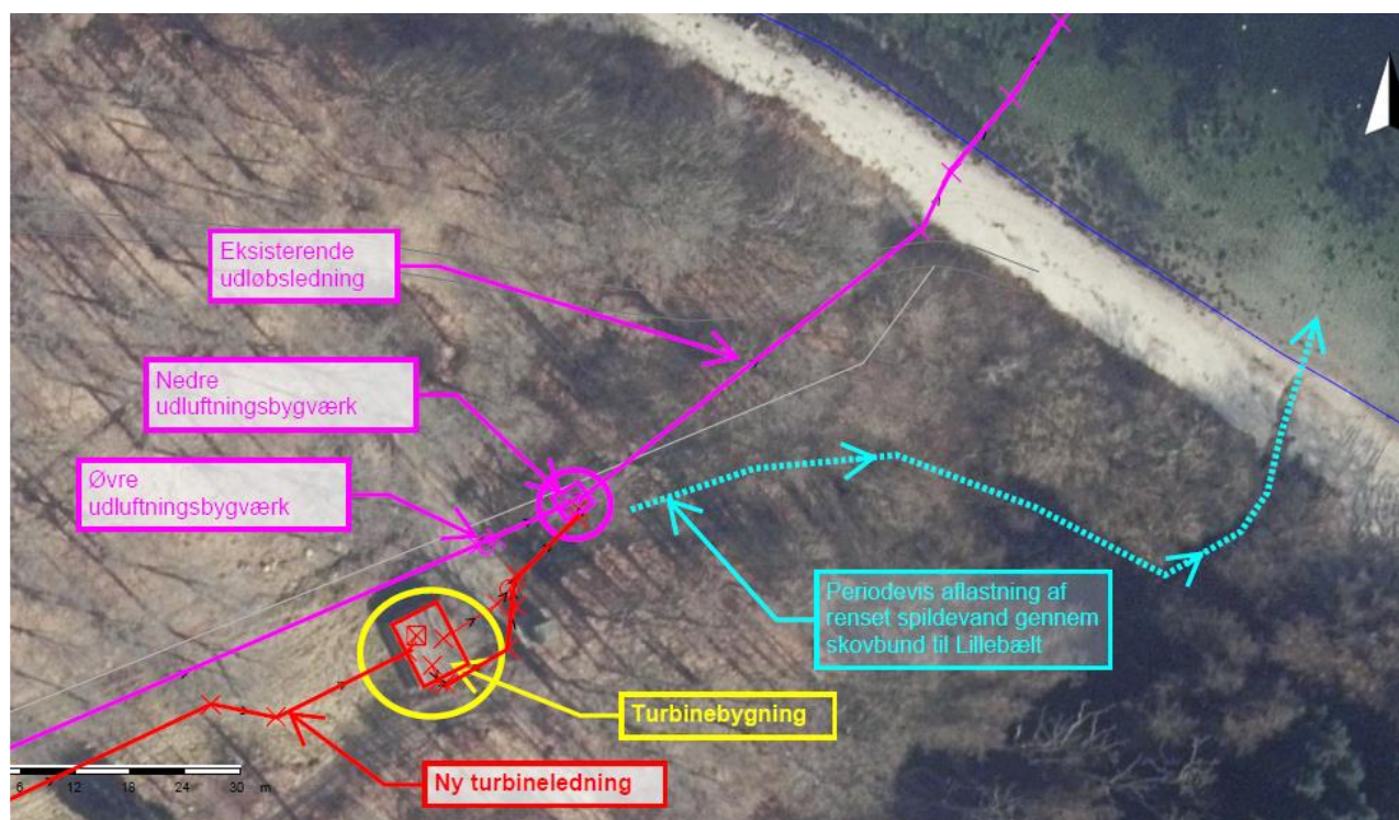
Figur 2. Placering af turbinebygning og udløftningsbygværk med nødoverløb
