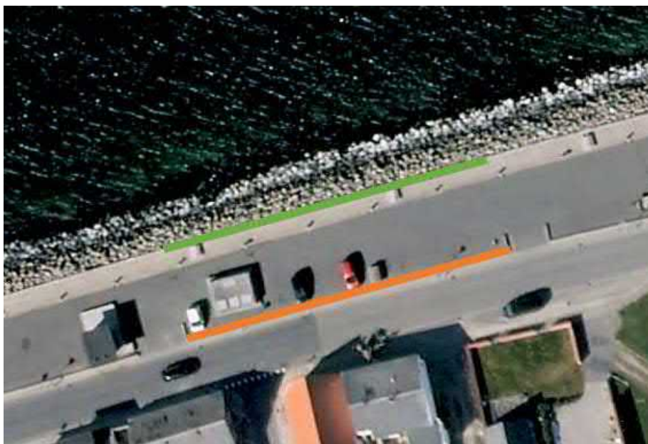
Figur 7: Klimasikring hvor Grøn = Formur (+2,2)/ Orange = Bagmur (+2,0).
