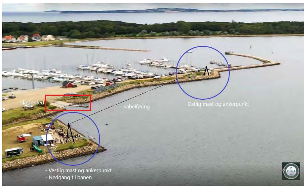
Figur 1: De fysiske forhold (slæbestedet markeret med rød firkant, kabelføring samt endemaster markeret med blå cirkler)
