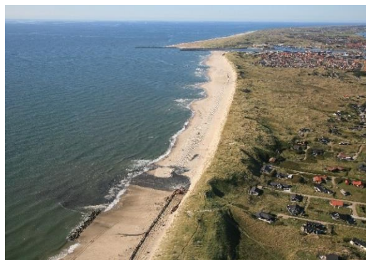
Figur 7-15. Luftfotoet viser kystlandskabet omkring Hvide Sande set fra syd mod nord. Byen ses øverst på fotoet, hvor den omkranser havnen og slusen til Ringkøbing Fjord. Langs stranden ses kystfodring ved Årgab, hvor læsideerosion fra havnens indsejling nødvendiggør hyppig strandfodring 29 .
