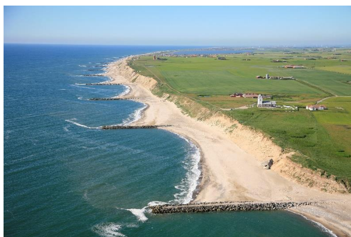
Figur 7-2. Kystens udformning. Øverst tv.: som følge af bølgebrydere. Øverst th.: uden hård kystbeskyttelse i havet. Nederst: som følge af høfder 16
