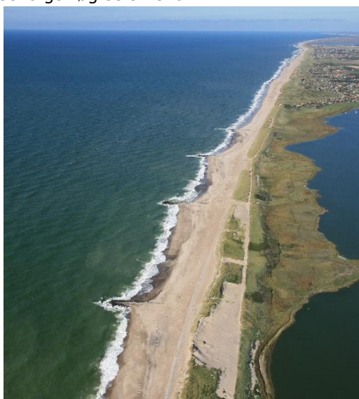
Figur 7-7. Det smalle klitlandskab set fra syd. I forgrunden ses den smalle tange mellem Vesterhavet og Ferring Sø, der er sikret ved høfder, skråningsbeskyttelse og diger 21 .
