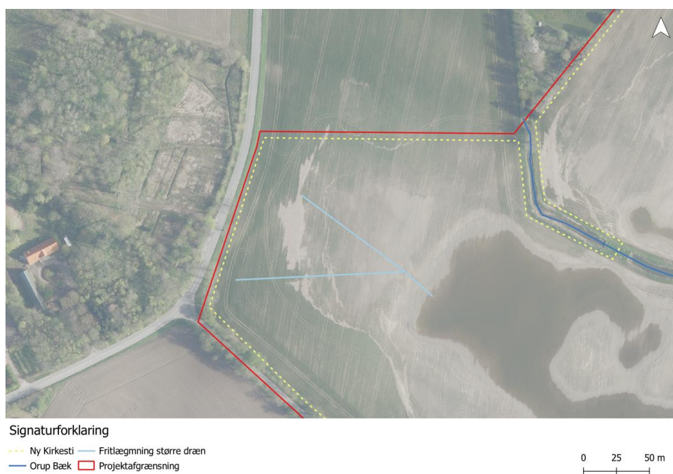
Figur 3-16 Fritlægning af de to større dræn fra Skovridderskoven.
