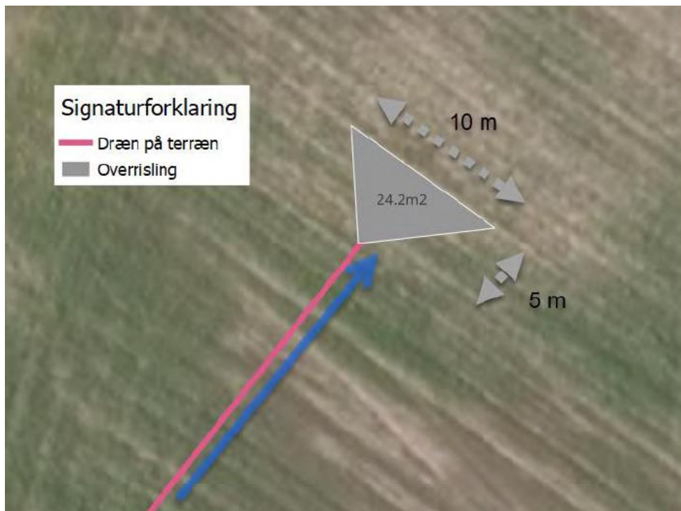
Figur 3-3 Principskitse af overrislingszonen ved udløbet af drænet. Drænvandet løber til overrislingszonen, som skal være ca. 5 m langt.
