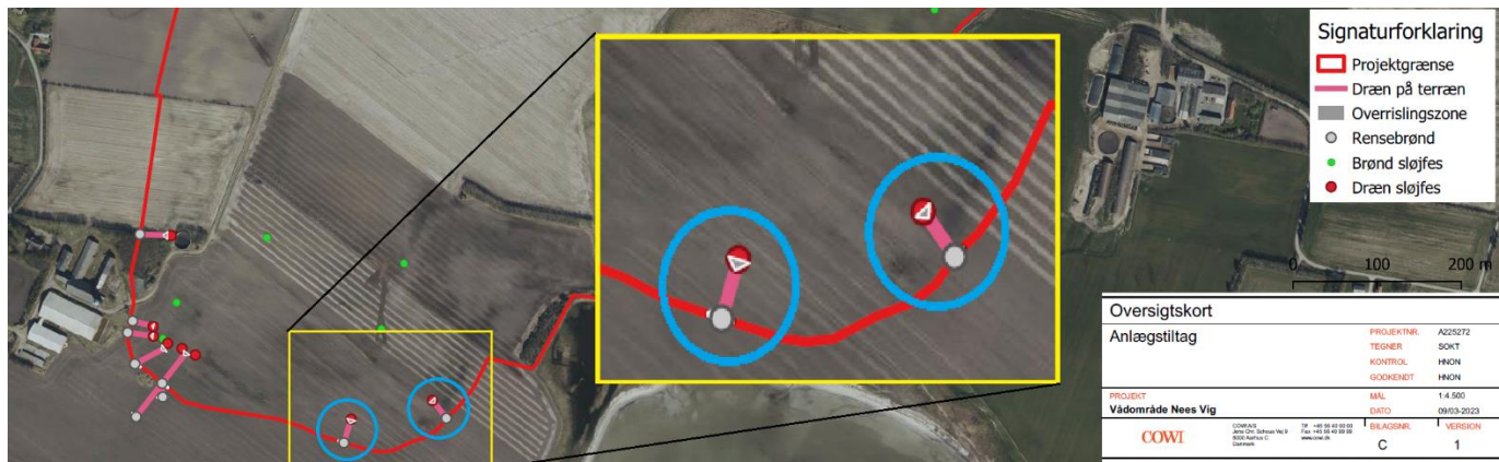
Fig. 5. Oversigt over drænudløb til overrisling inden for strandbeskyttelseslinjen. De blå cirkler markerer drænudløbene inden for strandbeskyttelseslinjen.
