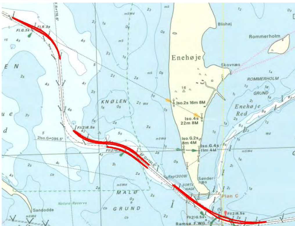
Figur 3.4: Alternativ udformning, udvidelse af alle sving af den eksisterende sejltrede illustreret med rød.
