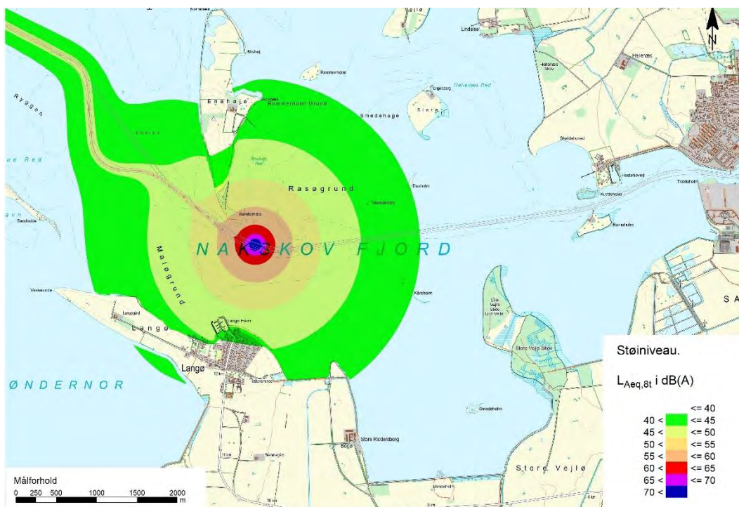
Figur 6.2: Støj fra uddybningsarbejde ved Langø og Enehøje, beregnet 1,5 m over terræn og vandoverflade.
