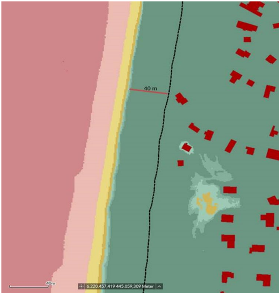
Fig. 1 Laserscanning af kystzonen ved Søndervig med højdeintervaller og sikkerhedslinjens beliggenhed i 2018 ud for Lodbergsvej i Søndervig.
