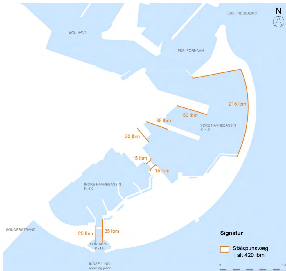
Fig. 3-11 Oversigt over stålspunsvægge, indre- og ydre havnebassin
