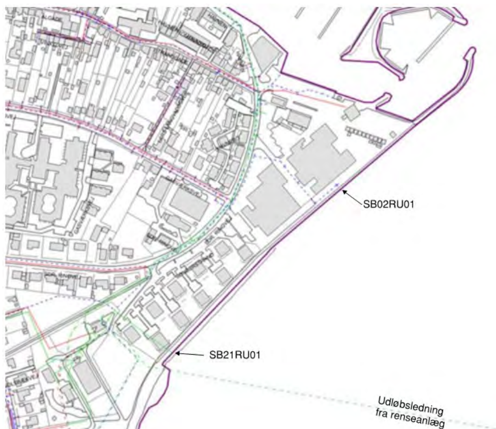
Fig. 7-35 Plan over ledningsforløb og eksisterende regnvandsudløb
