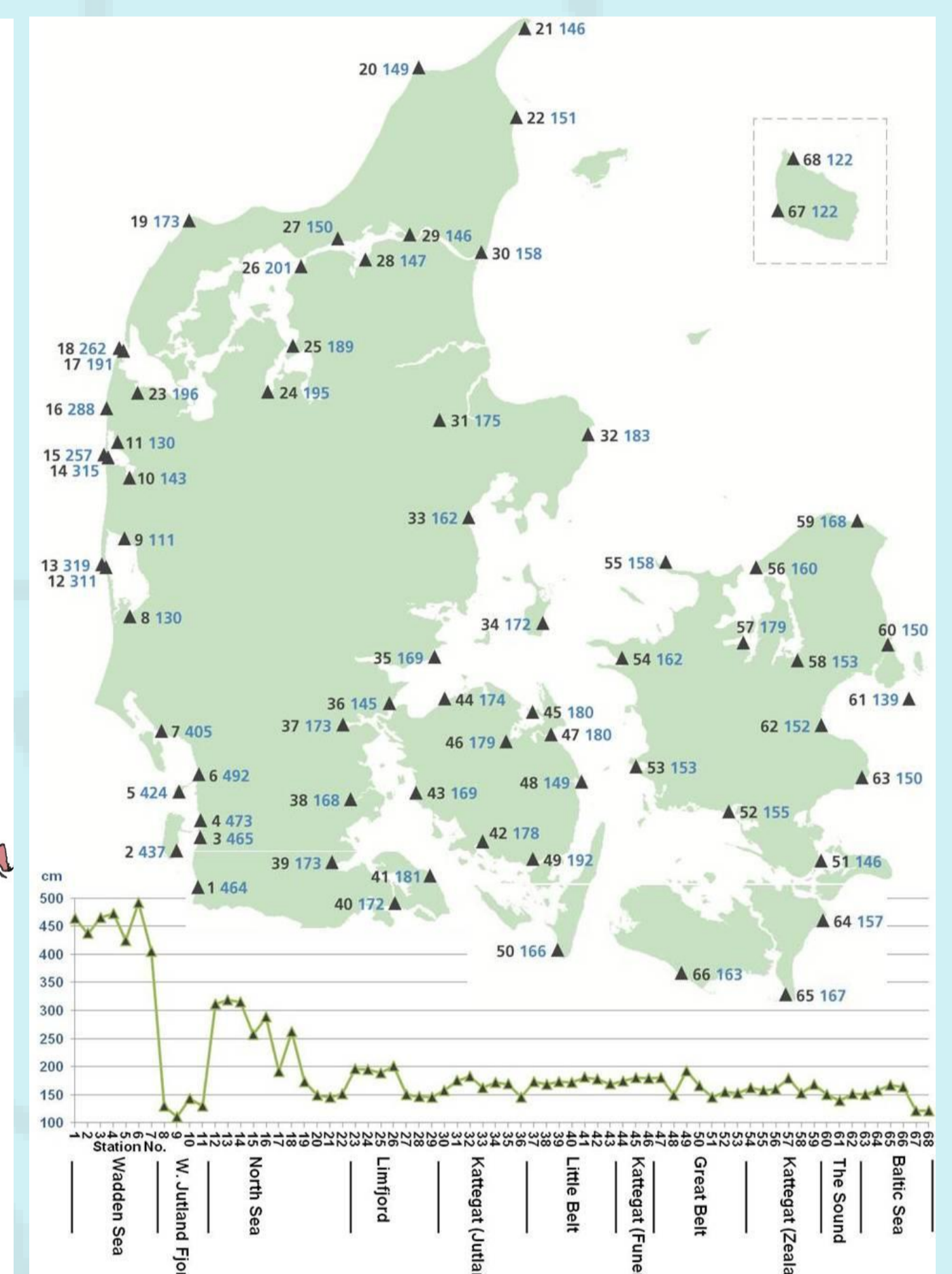
Figur 3 100-års hændelser (blå) i cm for de 68 danske målestationer med højvandsstatistikker og med den geografiske variation i stormflodshøjder skitseret nederst
