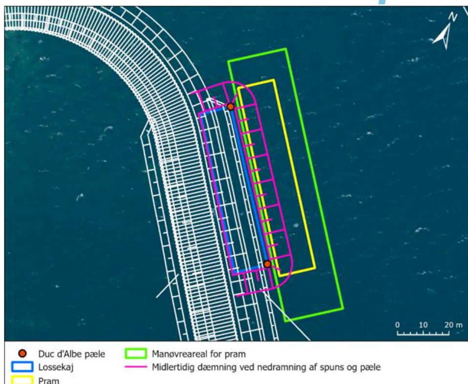
Figur 2-14 Udformning af lossekaj, hvor midlertidig dæmning der etableres ved variant 1 også fremgår.
