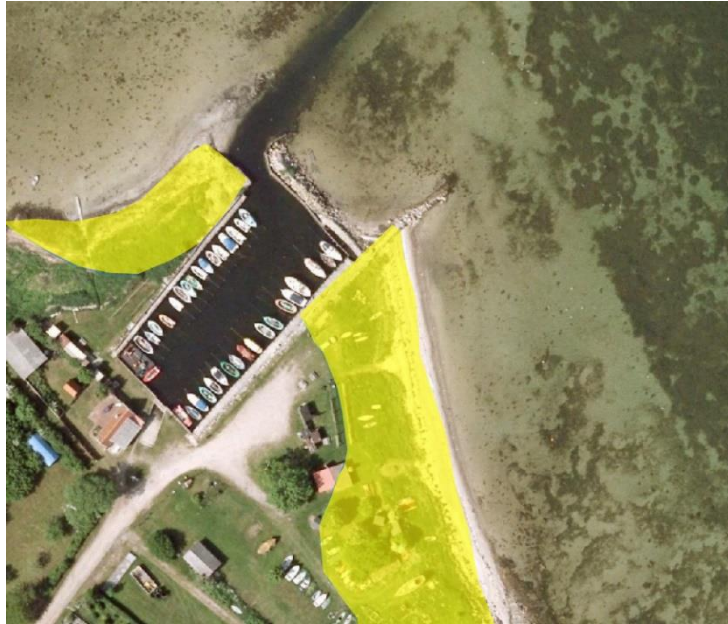
Fig. 4. Strandbyen Havn. De gule markerede områder er opbygget strandareal efter havnens anlæggelse.
