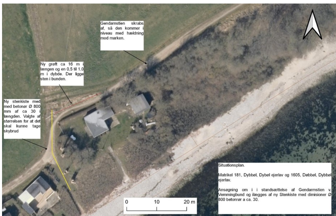
Figur 2. Kortmateriale fra ansøgningen viser del af Gendarmstien og placering af de ansøgte tiltag. Rørudløbet er placeret ned mod kysten ved afslutningen af den gule streg. Der er sket en projektilpasning, således at det eksisterende Ø200 rør suppleres med et Ø600 rør. Den nye grøft er desuden ca. 25 m lang og ikke 16 m som det fremgår af skitsen. Se også figur 3.
