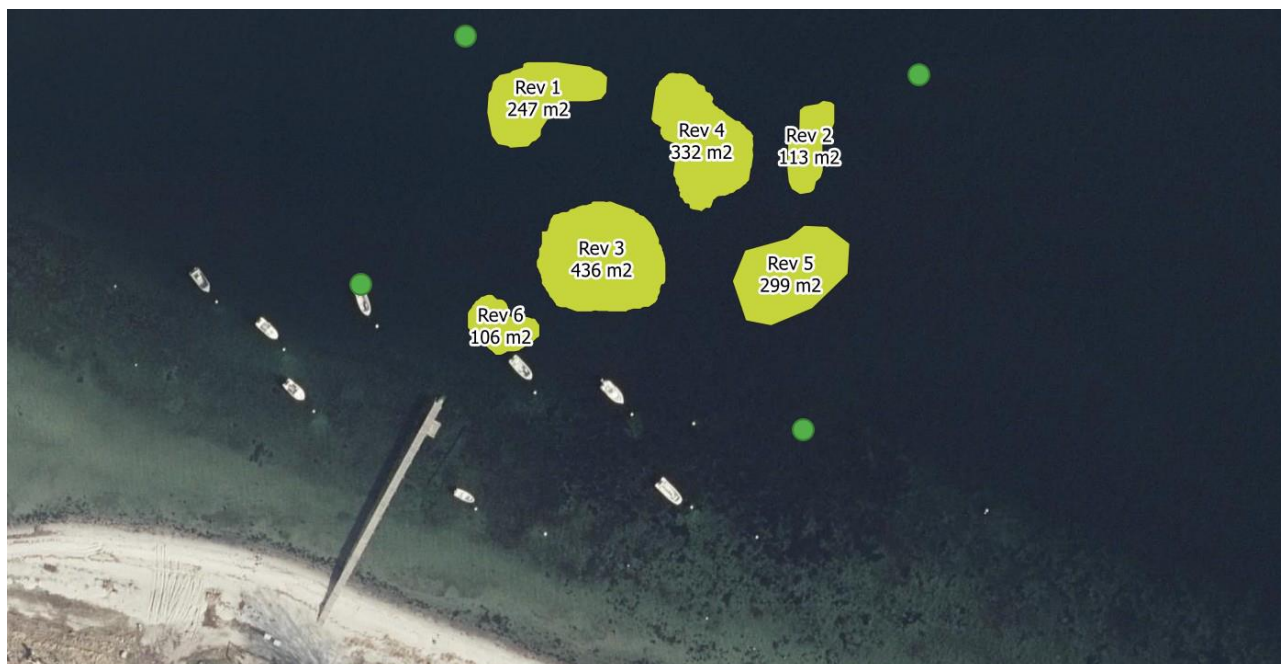
Figur 4. Design af stenrevet ved Gl. Ålbo. Bemærk at restruktur "rev1" er fjernet fra projektet, så projektet indeholder revstrukturene 2-6.
