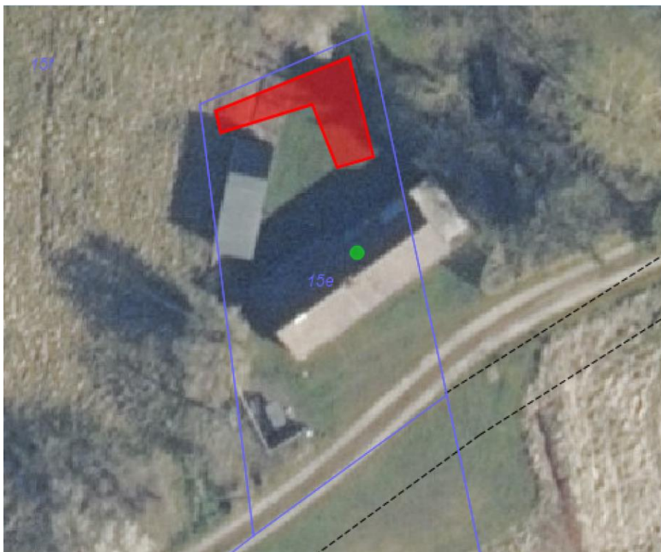
Ejendommen med placering af nedsivningsanlæg med hævet mile
