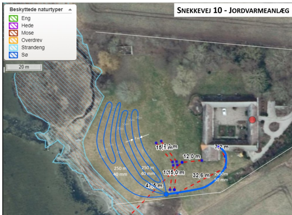
Fig. 2. tilsendt fra ansøger. Jordvarmslangerne er markeret med blå streger, hvor den tykkere blå streg angiver hovedledningen. Den ansøgte samlebrønd, der samler hovedledningen med jordslangesløjferne, er markeret med en blå prik.
