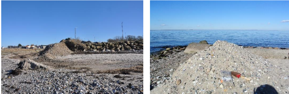
Figur 3: Oprensingsmateriale fra dels havneindløb, med stort indhold af finkornet og organisk materiale (til venstre), dels søjlrende, bestående af sand med sten op til 10 cm (til højre).
