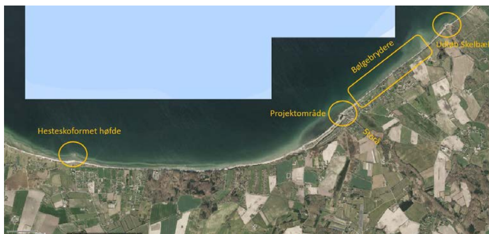
Figur 1: Overblik over kyststrækningen i Båring Vig med markeret projektområde samt interessante lokaliteter, herunder en række kystparallelle bølgebrydere øst for Storås udløb (arealinformation.dk).
