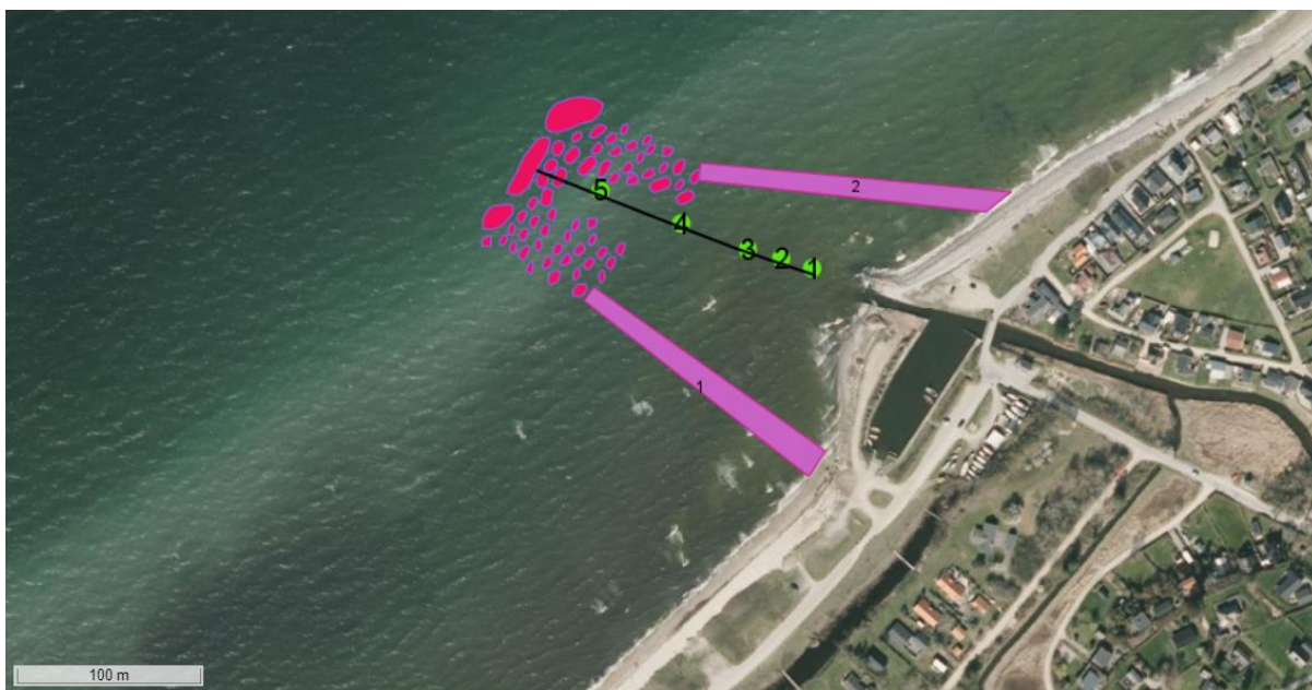
Figur 1b. Den sorte linje angiver sejlsadsretningen til og fra Varbjerg havn. Havnens brugere er lovet, at der laves en afmærkning, som bådene kan følge, så de ledes sikkert fri af og igennem revet. På denne linje vil der minimum være 1,5 meters vanddybde ved normal vandstand.
