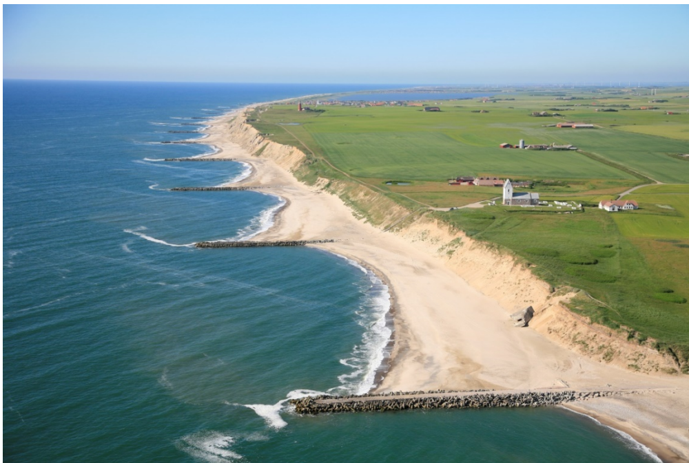
Høfdegruppe ved Vestkysten. Bemærk læsideoerosion og den karakteristiske savtakkede strand
