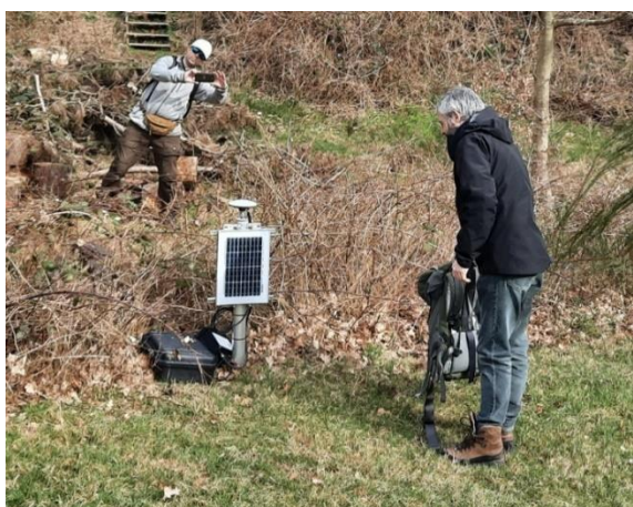
Eksempelvisning af GNSS-måler
