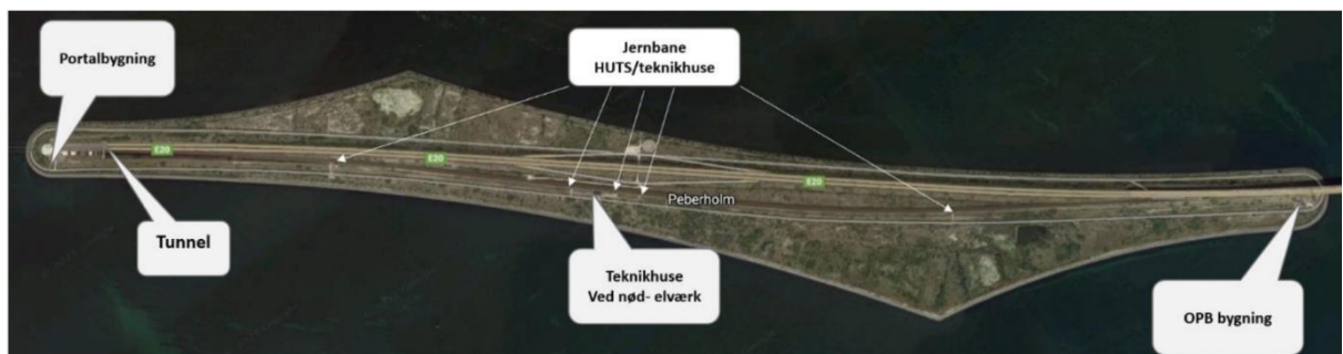
Figur 2-3 Anlægsdele, der er kritiske for at kunne holde Øresundsforbindelsen i drift.
