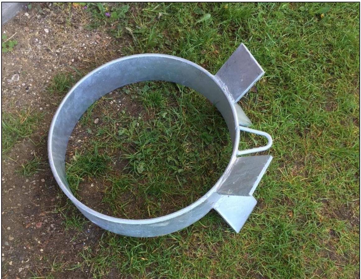
Figur 6: Billedet viser en galvaniseret P-ringe (25 kg/Ø 56 cm), som nedpumpes i sandbunden. Bådene fortøjes til en 2 m lang ankerkæde, der er fastgjort til P-ringen.
