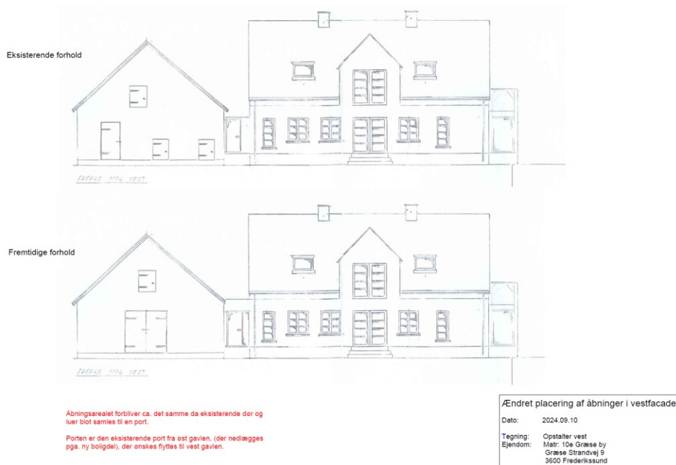
Figur 2: Tegning af udhusets vestfacade vedhæftet ansøgningen.
