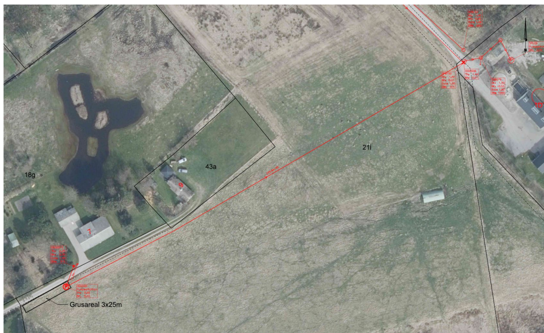
Fig. 3. Tilsendt fra ansøger. Plantegning af den ansøgte pumpestation med elskab markeret med rød prik samt trykledningen markeret med rød linje. Arealet markeret med en boks i venstre nederste hjørne er arealet som ansøges belagt med stabilgrus.
