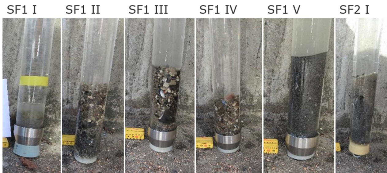
Figur 4: Fotos af de seks udtagne prøver. Sedimentet er sandet og med mange muslingeskaller, dog færre i de mere dyndede partier (SF1 I, SF1 V og SF2 I.).
