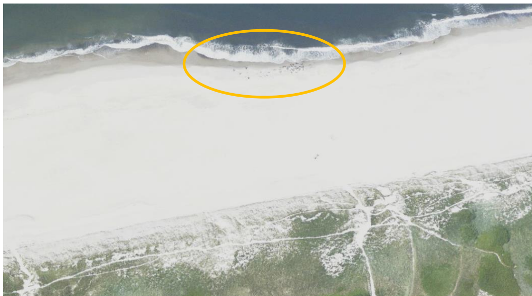
Figur 7-35. Centralt på fotoet er markeret en bølgebryder, som delvist er skjult af det tilførte sand fra en strandfodring.
