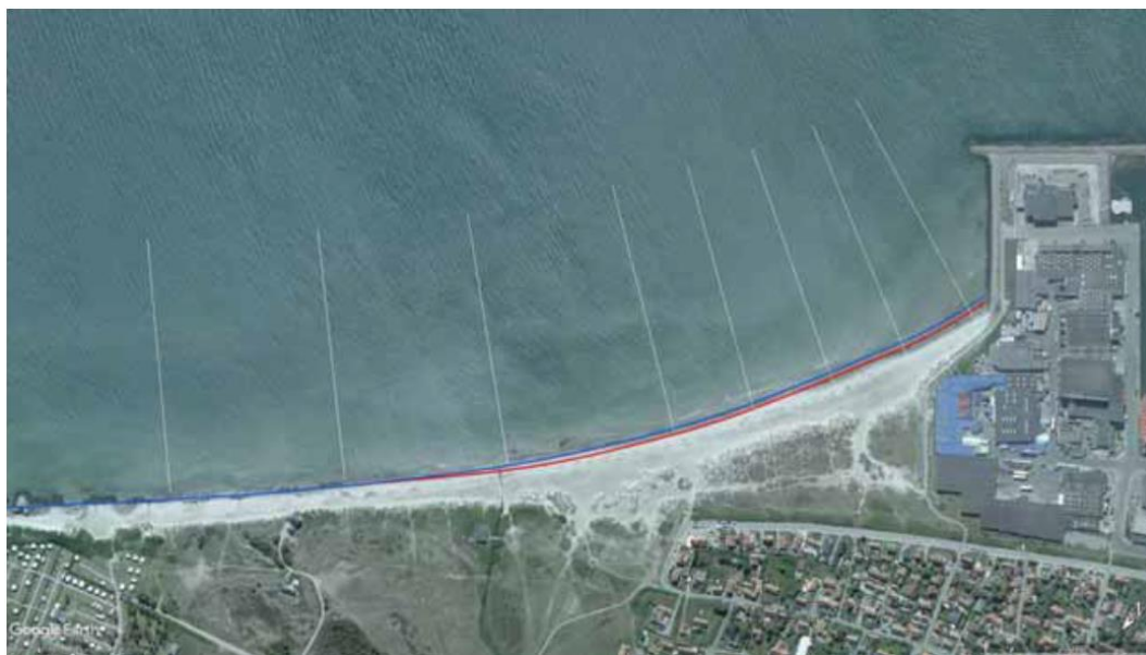
Figur 21-1. Skønnet fremtidig kystlinje optegnet i forhold til den eksisterende vist i baggrundsbilledet. Blå: Ny ligevægt. Rød: Ændringer på kort sigt hvor fremrykning nær havnen kompenseres af tilbagerykning mellem havnen og sydligste kystbeskyttelse. 568
